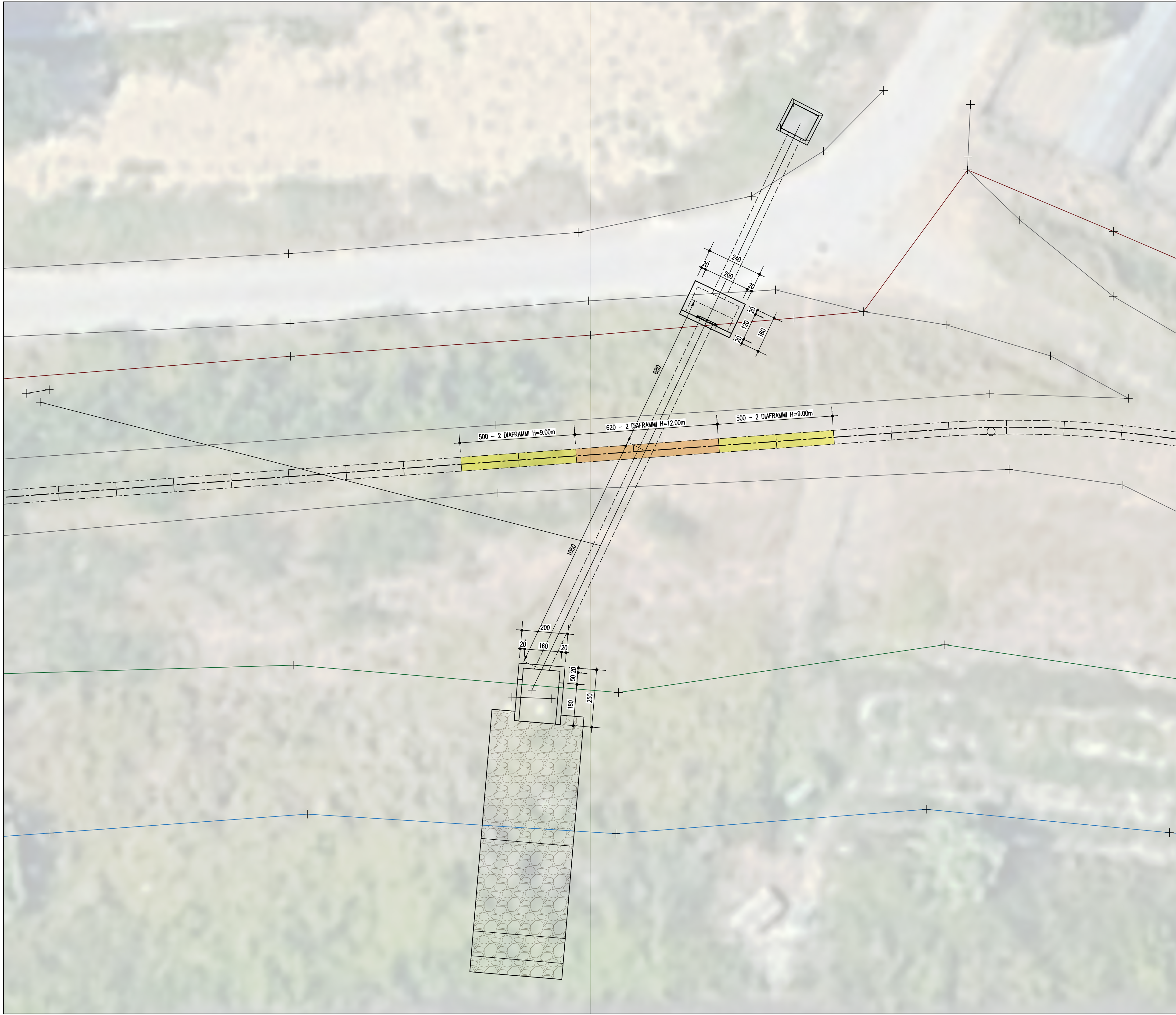
PIANTA OPERA DI SCARICO km 0+930.40 SCALA 1:100
