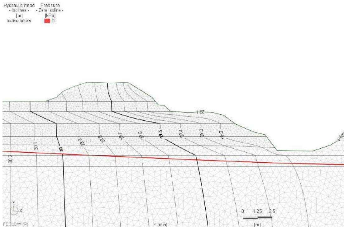
Fig. 45 - Condizioni di partenza della simulazione di piena lungo il Torrente Grizzaga (la linea rossa corrisponde alla curva di saturazione mentre le linee nere a curve di ugual carico idraulico)
