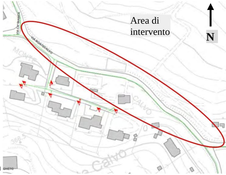
Figura 4: planimetria del tracciato della rete gas (scala libera)
