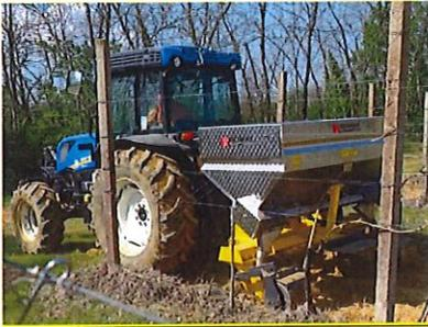
concimatore di precisione per la distribuzione nel sottofila ( con interrimento o superficiale ) adatto a concimi pellettati e/o granulari , nel quale si imposta la dose in kg/ha sul computer interno e mantiene la quantità distribuita indipendentemente dalla velocità effettuata:
