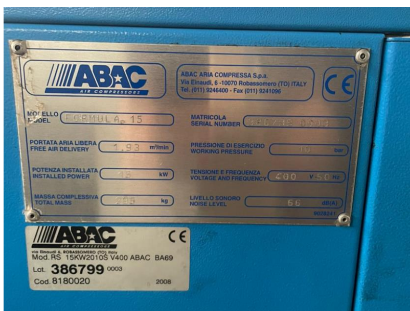
Figura 1: matricola vecchio compressore
